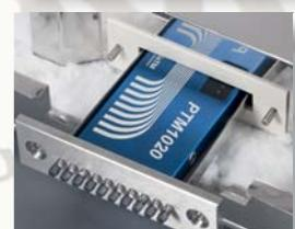
Raccords en acier pour assurer l'étanchéité ainsi que la protection des thermocouples
